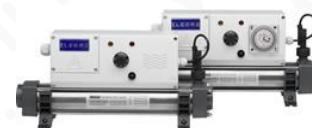
Электронагреватели воды, указанные здесь, приспособлены для работы с хлорированной водой. Электронагреватели бывают мощностью от 2 kW до 18 kW и в них вмонтированы регуляторы температуры от 0 до 40°C. Больше всего электронагреватели употребляют электроэнергии при начальном нагреве воды, после чего электронагреватели удерживают установленную температуру автоматически включаясь и отключаясь.
