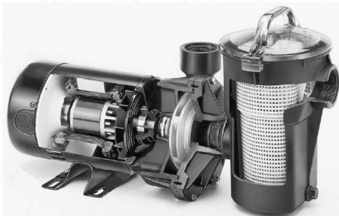
Фильтрационные насосы оборудованы вакуумной камерой, так называемой предфильтровой камерой. Предфильтровая камера должна быть заполнена водой, чтобы насос смог создать вакуум. Когда насос включён, предфильтровая камера полна воды, когда выключен, камера может быть частично заполнена водой.
